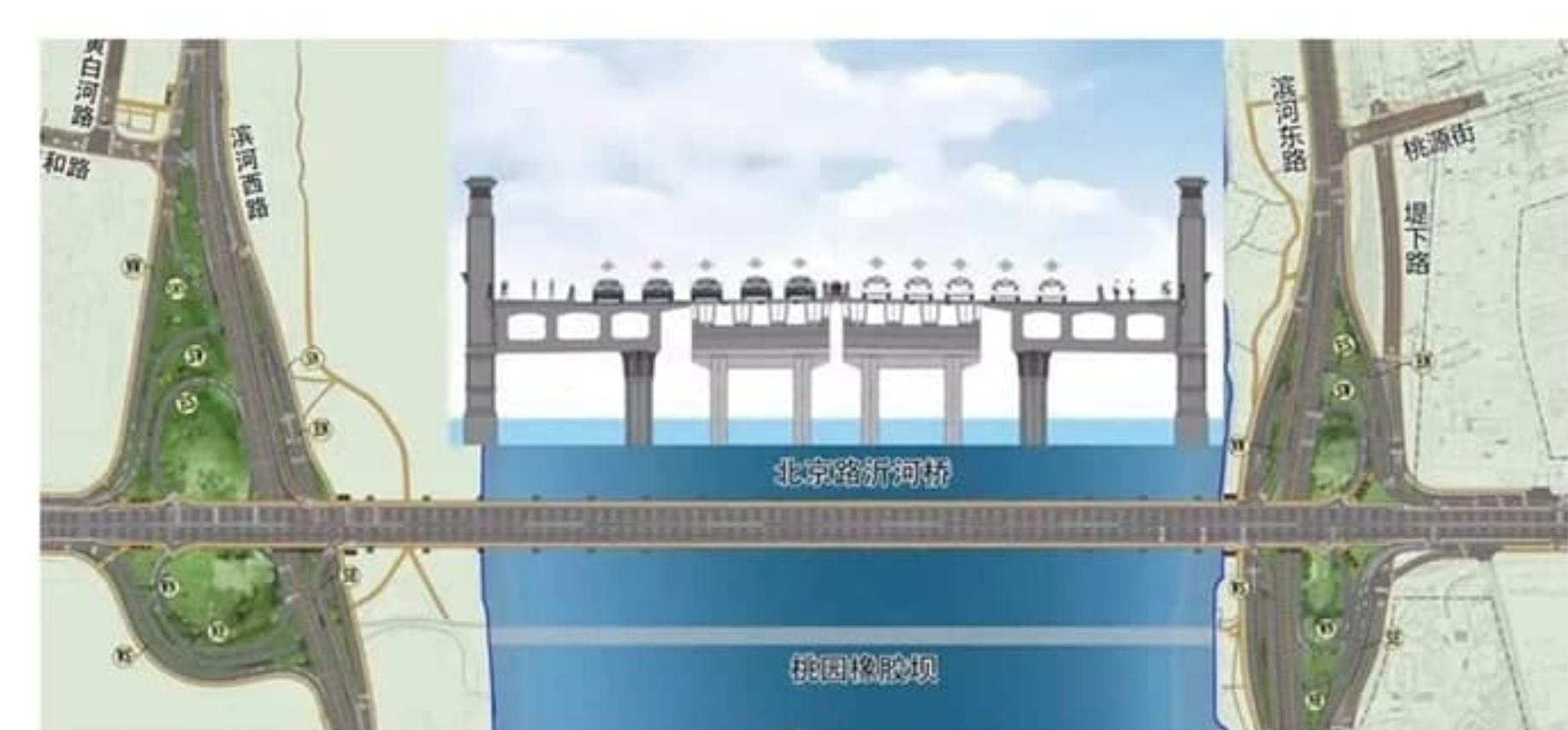
主题，采用人民大会堂的建筑风格元素进行设计，4 根高大挺拔的圆柱与 4 面大玻璃窗组成了桥头堡的建筑框架。桥头堡整体外观体现了均衡对称、庄重典雅、朴素壮观的建筑风格。
